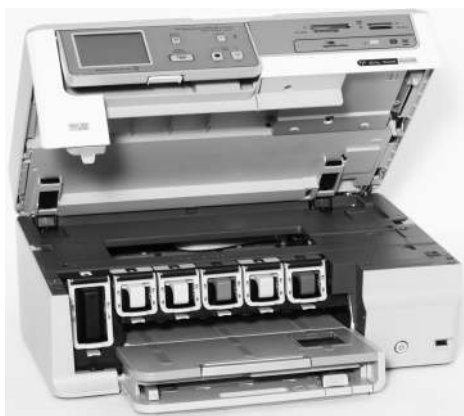
Gedruckt wird mit 6 Farben: Schwarz, Gelb, Hell-Cyan, Cyan, Hell-Magenta, Magenta. Schwarz ist extra groß und der Druckkopf ist separat. Bei diesem System wird jeder Tintenpfropfen genutzt
