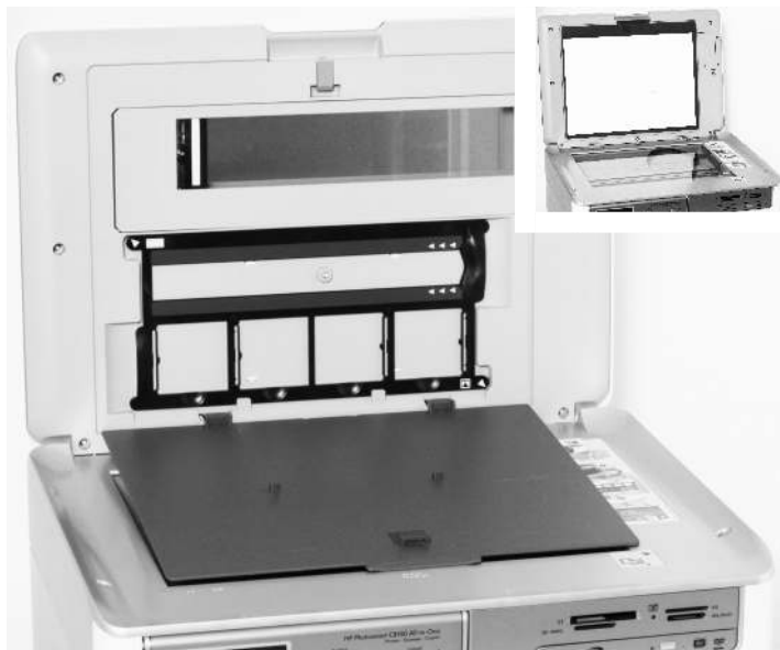
Die Durchlichteinheit zum Scannen von Kleinbildfilm ist im Deckel des Scannerteils integriert. Dort eingeklemmt stehen Halter für KB-Filmstreifen und KB-Dias. Das kleine Bild rechts oben zeigt die normale Verwendung für Aufsichtsvorlagen wie Papier, Bücher etc.
