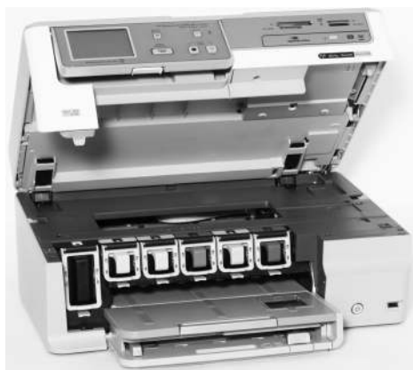
Gedruckt wird mit 6 Farben: Schwarz, Gelb, Hell-Cyan, Cyan, Hell-Magenta, Magenta. Schwarz ist extra groß und der Druckkopf ist separat. Bei diesem System wird jeder Tinten-tropfen genutzt
