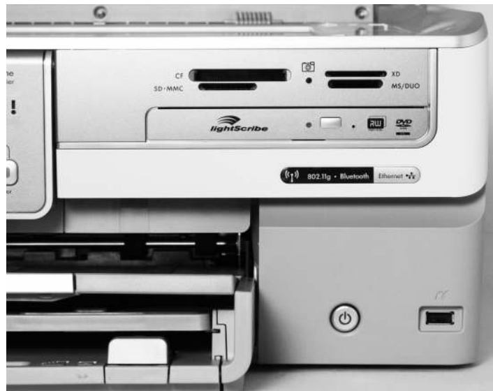
Alle denkbaren Varianten für die Dateneingabe: Steckplätze für CF-, xD-Picture-, MM/SD-Karten und Memory Stick sowie USB-Host-Schnittstelle für sowohl USB-Laufwerke/USB-Sticks als auch Direktdruck von Kameras via PictBridge oder auch über Bluetooth. Außerdem: DVD-Brenner zum Lesen und Sichern von Fotodaten
