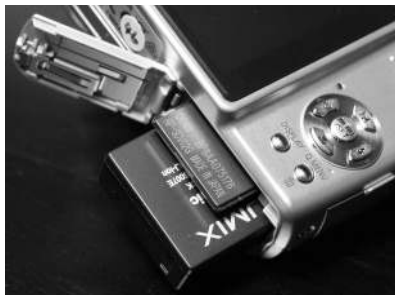
Lithium-Ion-Akku und SD(HC)-Karte-Steckplatz hinter der Klappe auf der Bodenseite der TZ5
