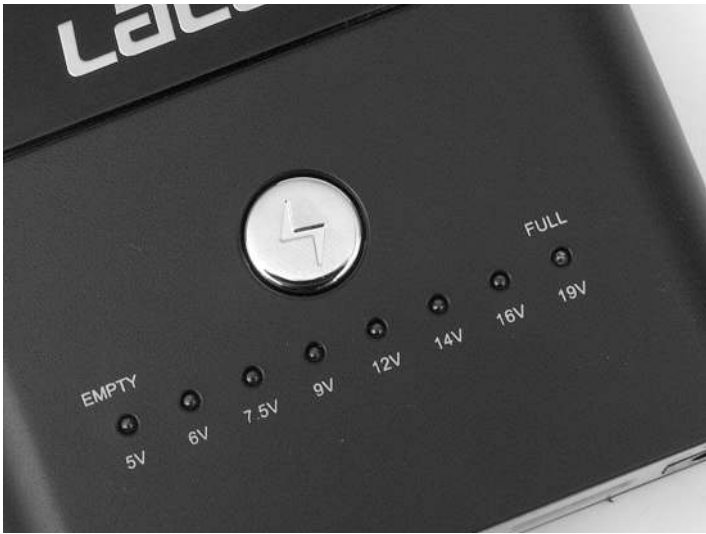
Die Ausgangsspannung kann in 8 Stufen gewählt werden. Die Werte passen für die meisten elektronischen Kleingeräte und Notebooks. Die LED-Kette dient auf Tastendruck auch als Kapazitätsanzeige
