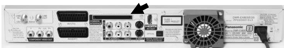
Anschlussfeld auf der Rückseite des Panasonic DMR-EX80S: Common-Interface-Steckplatz (Pfeil) für eine Decoder-Karte sowie wichtiger HDMI-Ausgang. Der Lüfter sieht dramatisch aus, entwickelt aber nur geringfügige, im Betrieb nicht hörbare Geräusche
