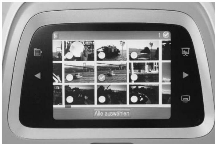
Hier die Auswahl der Bilder über den groß dimensionierten Touch-Screen. So wie hier die Schaltflächen sehr eindeutig die möglichen Funktionen zeigen, gibt es auch ausführliche Text-Erläuterungen zu allen Bedienschritten, was das Handbuch praktisch ersetzt
