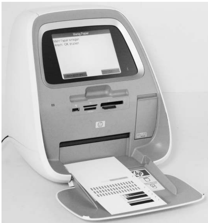
Kompakte Foto-Print-Station: HP Photosmart A826, hier mit einem gerade fertigen Probeausdruck zur automatischen Kalibrierung
