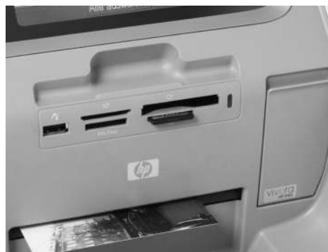
Unterhalb des Bildschirms sind links die USB-Schnittstelle, die Speicherkarten-Steckplätze und rechts die Klappe für die Tintenpatrone
