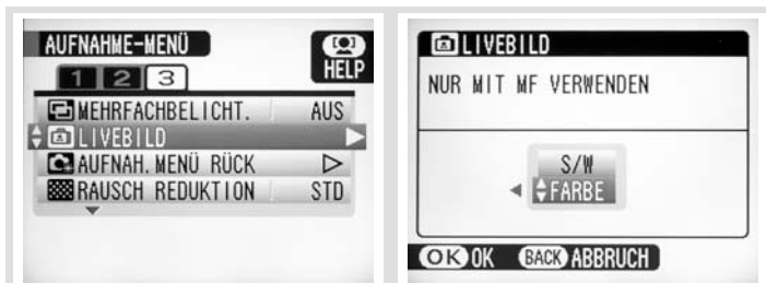
Bei Livebild-Wiedergabe wird für maximal 30 Sekunden das Bild direkt vom Sensor gezeigt. In diesem Modus ist nur manuelles Focussieren möglich
