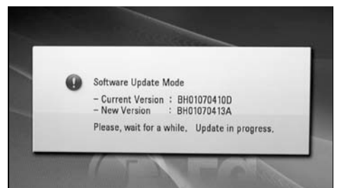
Wie inzwischen gängig bei Disc-Playern ist auch beim BH100 bei Bedarf das Updaten der Firmware über eine Disc möglich
