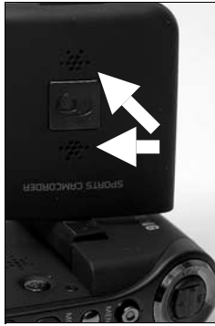
Die beiden Mikrofone sind beim Neuen nicht mehr oben am Camcorder sondern in der Rückseite des Monitors (Pfeile)
