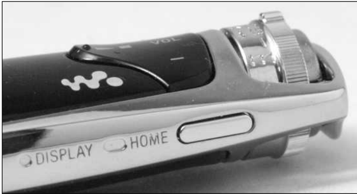
Die Bedienelemente und Anschlüsse des Sony Walkman NW-S703F: Über den Drehtaster werden die so genannten Laufwerksfunktionen bedient. Das funktioniert Einhändig und nach kurzer Eingewöhnung sogar blind in der Hosentasche
