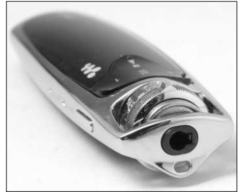
Die Bedienelemente und Anschlüsse des Sony Walkman NW-S703F: Über den Drehtaster werden die so genannten Laufwerksfunktionen bedient. Das funktioniert Einhändig und nach kurzer Eingewöhnung sogar blind in der Hosentasche
