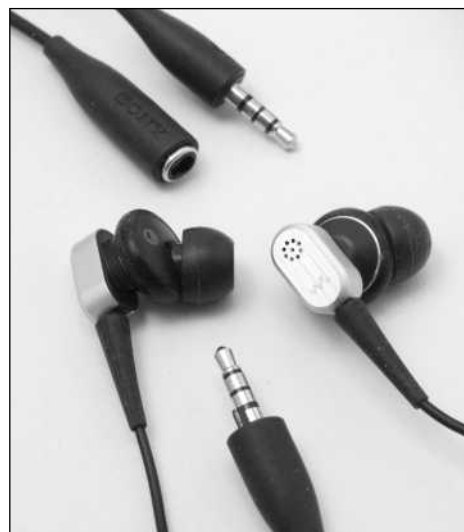
Mitgelieferte In-Ear-Ohrhörer mit integriertem Mikrofon für Gegenschall-Technik
