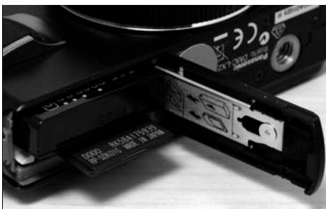
Steckplatz für SD-Karte wie konventionell bei kleinen Kameras kombiniert mit Akku
