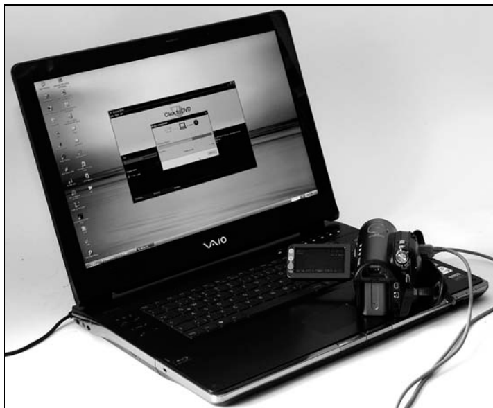
Sony VGN-AR11S VAIO Notebook: Erster in Europa erhältlicher Notebook-PC mit integriertem Blu-ray-Disc-Brenner
