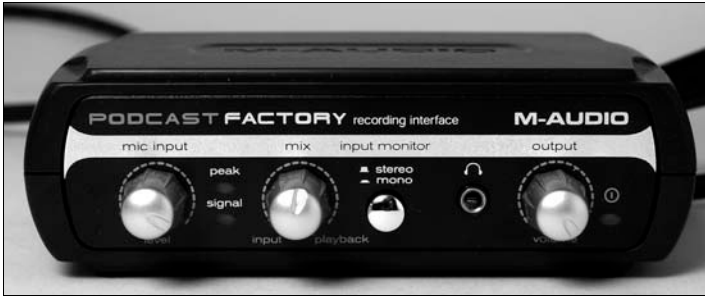
Der kleine Mixer zu M-Audio Podcast Factory ist einfach aber komplett ausgestattet. Wie hier ersichtlich gibt es zahlreiche Anschlüsse. Die Verbindung zum PC erfolgt via USB-Schnittstelle
