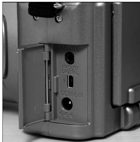
Anschlussfeld auf der linken Seite: Kabel-Fernbedienung, Standard-USB, Speisung
