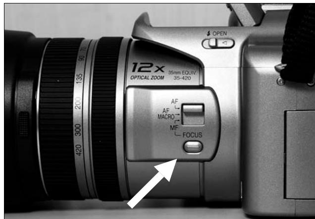
Griffgünstig an der linken Seite des Objektivs wird der Betriebsmodus für die Focussierung eingestellt
