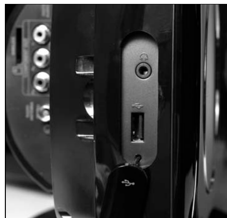
Seitliche Anschlüsse hinter einer Plastik-Abdeckung für USB und Kopfhörer
