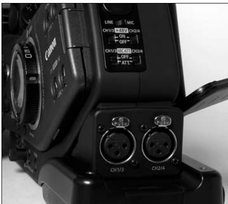
XLR-Buchsen mit wirklicher 48-Volt Phantomspannung für symmetrische Profimikrofone
