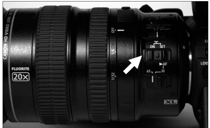
Voreinstellungen für Focus und Zoom können geladen werden, wofür es einen Schalter am Objektiv gibt (Pfeil); wo er erwartet wird. Zudem: Drehring für Neutralsdichte-Filter bis 1/32
