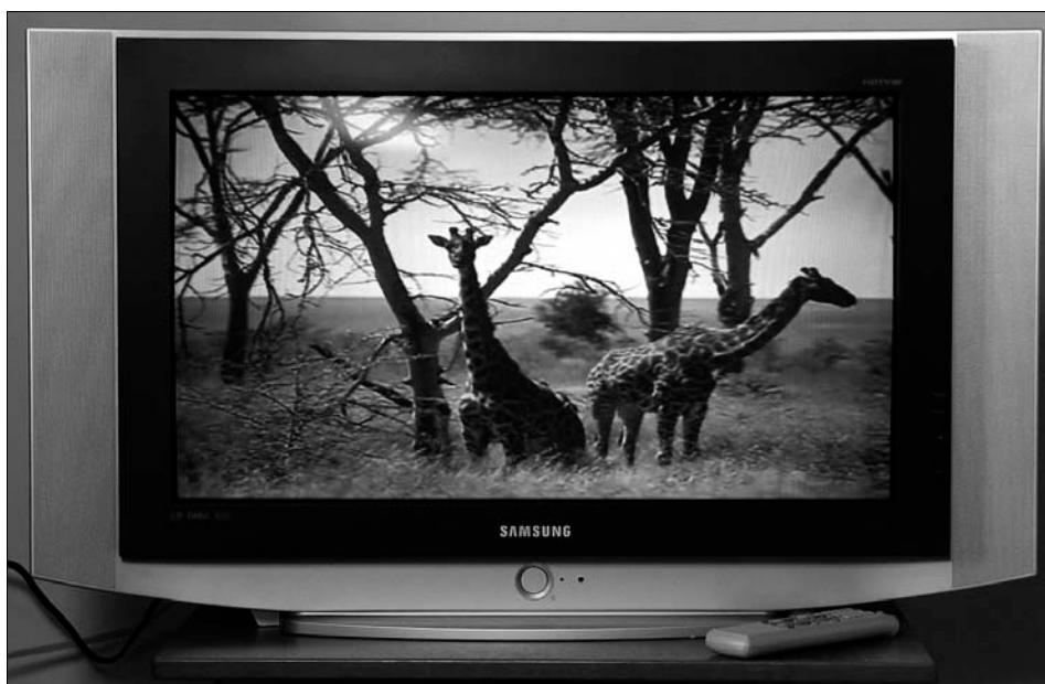
Samsung WS-32Z308P SlimFit: Schaut aus wie ein LCD-Fernseher, ist aber ein Röhrenfernseher mit besonders kleiner Tiefe durch eine neue SlimFit-Röhre
