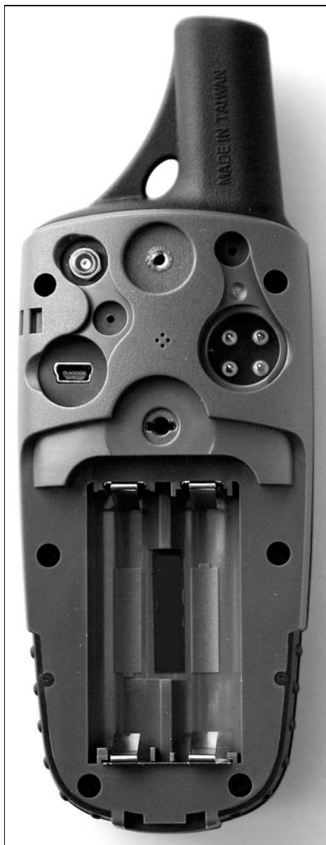
Die Rückseite des GPSmap 60CS. Unten das geöffnete Batteriefach und oben in Leserichtung: Antennenanschluß, Halterung, Mini-USB-Buchse und der spezielle RS-232-Anschluß (4-polig)
